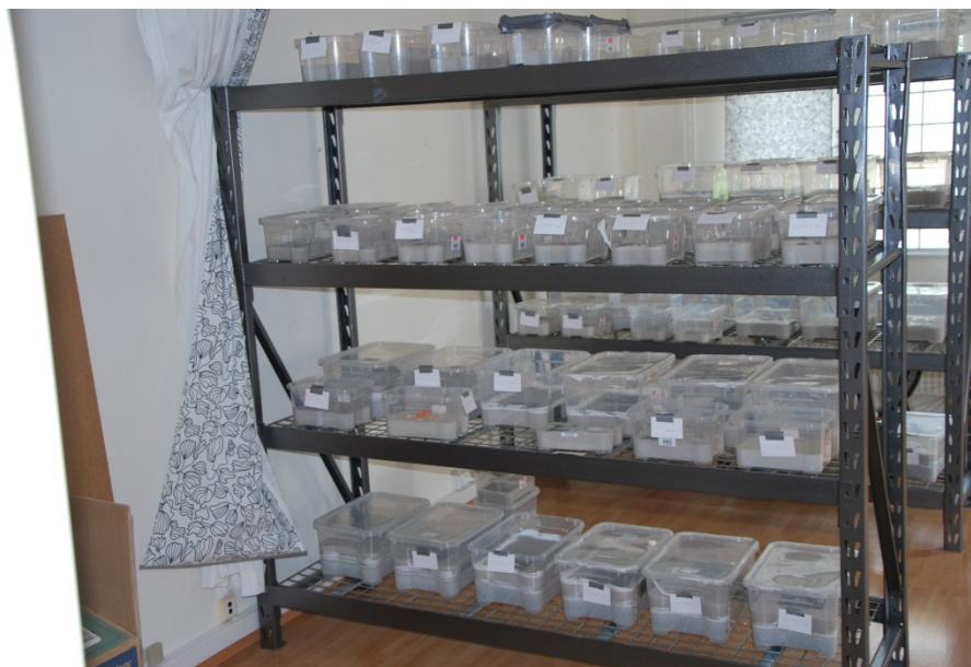
Bild 3: Förvaring av provbackar under 6 månader i rumsklimat.
