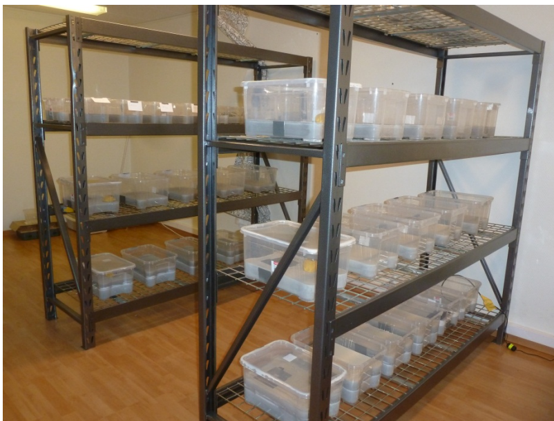
Bild 1: Förvaring av provformar under uttorkningstiden.
